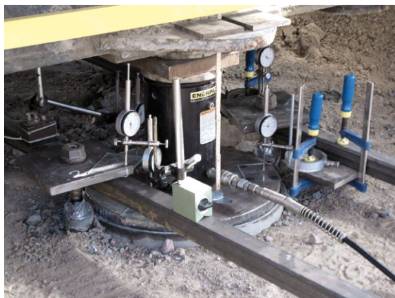
Силовой цилиндр и датчик перемещения при типичной пробной нагрузке
